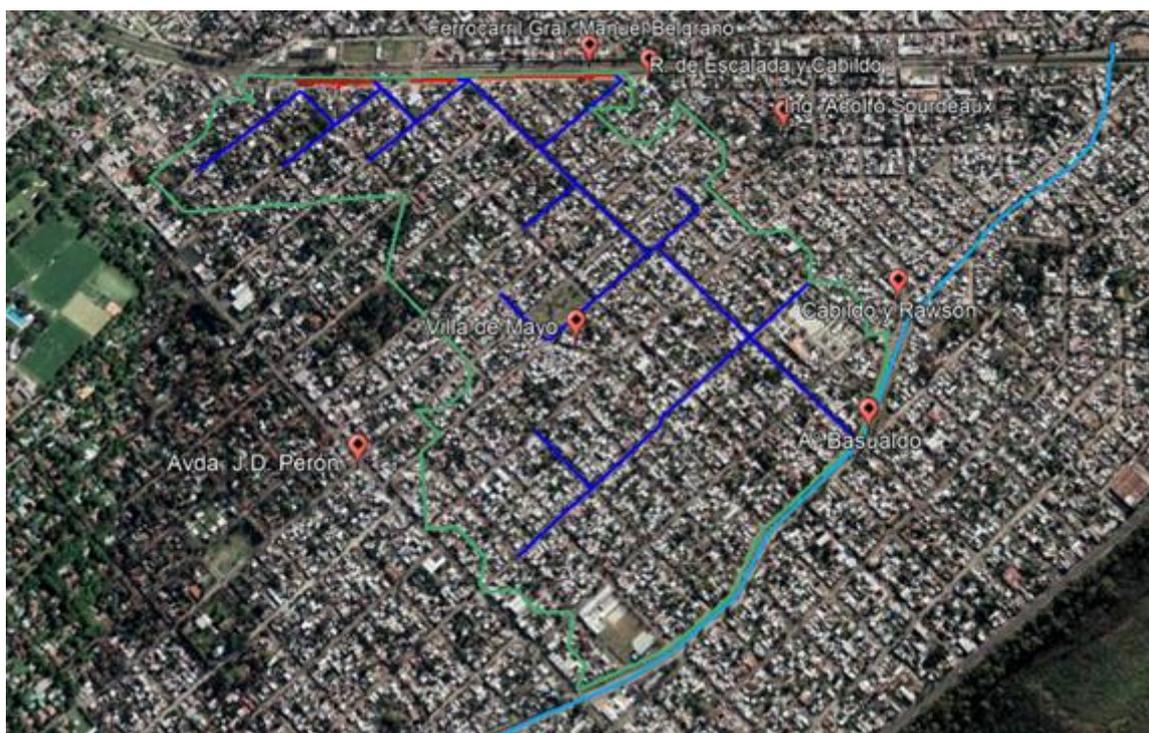
**Figura 12** Detalle de la traza de implantación del proyecto, Red pluvial existente a utilizar (rojo), Red Pluvial a ejecutar (azul).
